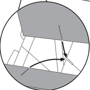
屋根本体の裏面を、矢印の溝に差し込みます。
