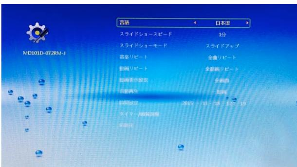
メニュー画面で「設定」またはリモコンの「SETUP」を押すと、左画面が表示されます。設定する項目を選択リモコンボタン▲▼で移動すると、詳細設定が反転します。
